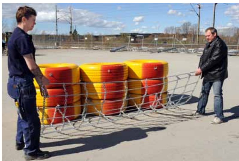
Driftsättning. Lyft av kedjematta från transportkrokarna.
